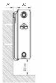
■ рисунок 3 - Крепление к стене радиатора ЛУ
